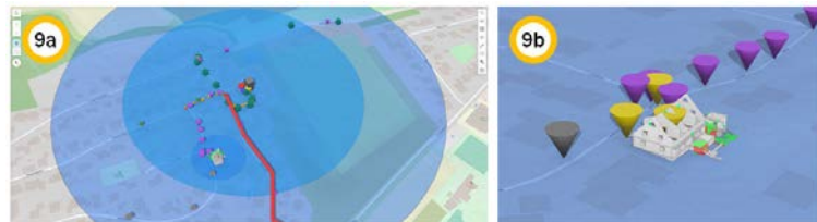
Abb. 9a-b: Links: georeferenzierte Visualisierung des Digitalen Zwillings mit diversen IoT-Car-/Smart-Home-Devices, in einer 3D-Projektion, kombiniert mit einer räumlichen Analyse. Rechts: Detailansicht vom Digitalen Zwilling. Umsetzung: ArcGIS, Vectorworks / EliteCAD, Lumion
