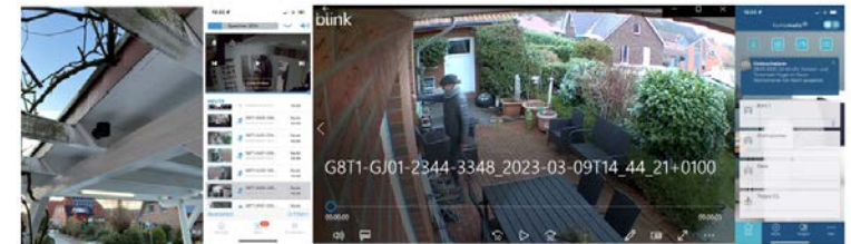
Abb. 1: Digitale Spuren. Von links: Kameraposition im Außenbereich, zugehöriges Datenprotokoll mit Aufzeichnungen der Handy-App (Fa. Blink), Aufzeichnung des Täters in Aktion, Datenprotokoll der Smart-Home-App vom System Homematic – Einbruchsalarmmeldung. Umsetzung: eigenes Bildmaterial
